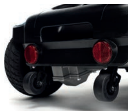
Roues anti-basculement pour plus de sécurité
